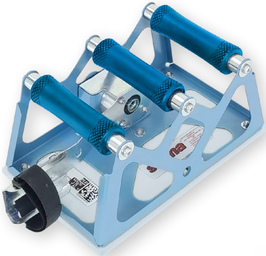
Battipiatrelle Elettrico Vibrante con attacco universale per smerigliatrice da 700 a 1400 W. Perfetto per la battitura delle piastrelle e guaine impermeabili , permette la corretta espulsione dell’aria . Utilizzando una smerigliatrice con variatore è possibile regolare l’intensità della vibrazione in base alle esigenze. Dotato di fondo Anti-Segno con area vibrante 30x19cm e impugnature ergonomiche. Maneggevole dal peso contenuto (3 kg senza smerigliatrice). *smerigliatrice non inclusa
